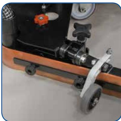
opérateurs. Le disjoncteur thermique prévient des problèmes au moteur en cas de surchauffe due à un usage impropre de la part de l'opérateur. Le suceur assure un séchage parfait sur tout type de sol, même en cas de joints larges. Les roues anti-trace évitent de laisser des marques après
