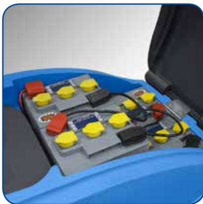
Accès rapide au logement des batteries et du moteur d'aspiration sans outils. Réservoirs en polythène ayant une grande résistance aux chocs et aux acides, et ayant une grande capacité (88 l), évitant les arrêts fréquents pour le remplissage. 4 batteries x 6 V - 180 Ah C5 qui
