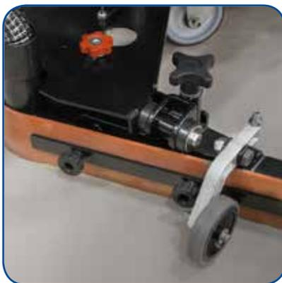
a un mal uso por parte de operador. La boquilla de secado en forma de V es apropiado para todo tipo de suelos, incluso suelos con juntas larga. Ruedas sin marca para evitar dejar marcas después del secado. Plenamente adaptable a cualquier superficie.
