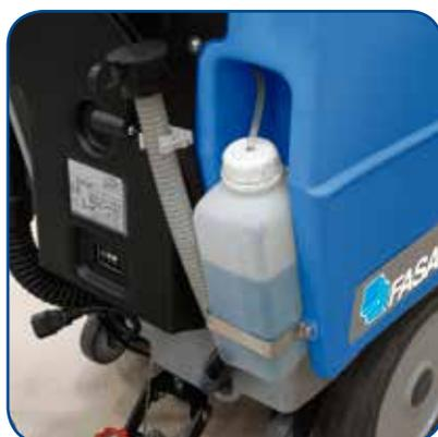
propre. Réglage de la solution détergente. Système d'évacuation de l'eau avec régulation du flux. Accès rapide au réservoir de récupération, facilement contrôlable. Extrêmement silencieuse (62 dB) grâce au logement particulier du moteur d'aspiration et
