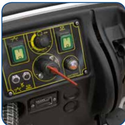
Panneau de commande analogique, simple et intuitif. Levier de commande par actionnement de la brosse et refoulement de la solution détergente. Clé pour allumage/arrêt et exclusion de la batterie, interrupteur du moteur des brosses et du moteur
