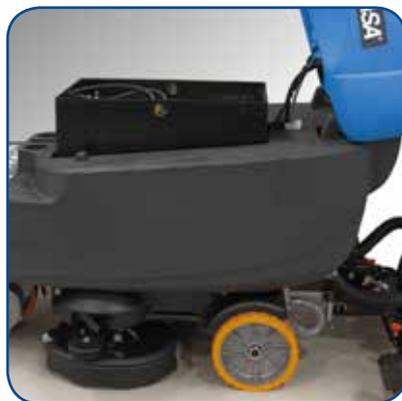
de horas, mando de control de la velocidad e indicador de falta de la solución detergente. Todos los motores están protegidos por disyuntores térmicos. 80 kg de presión continua de los cepillos con sistema de auto-nivelación para eliminar eficazmente cualquier tipo de suciedad en todos los suelos.
