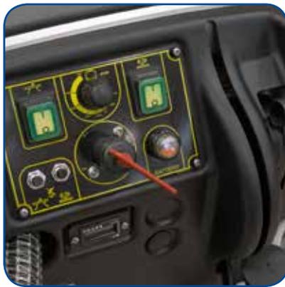
Panel de control analógico fácil e intuitivo. Palanca de transmisión del cepillo y de la solución detergente. Llave de encendido/apagado y de exclusión de la batería, interruptor motor cepillo y motor de aspiración, sistema de dosificación de los
