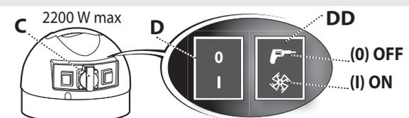
**IT** Per attivare la funzione presa elettro-utensile è necessario posizionare l'interruttore **D** su (I)ON e l'interruttore **DD** su (O) OFF. Con utensile inserito, l'aspiratore si accende all'accensione dell'utensile. Il tubo di aspirazione collegato aspira direttamente polvere, trucioli.
